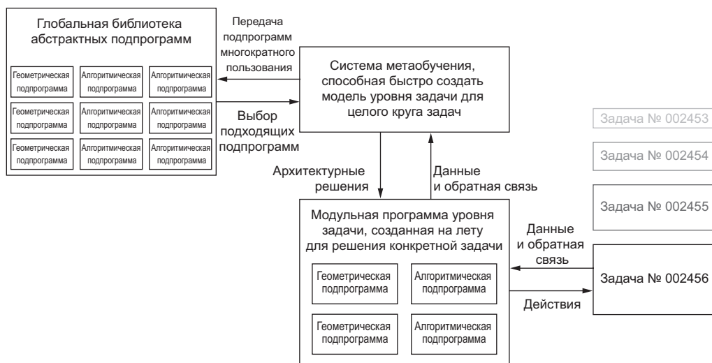
Рис. 9.6. Система метаобучения, способная быстро разрабатывать модели для конкретных задач, используя примитивы многократного пользования (алгоритмические и геометрические), и таким способом достигать экстремального обобщения
