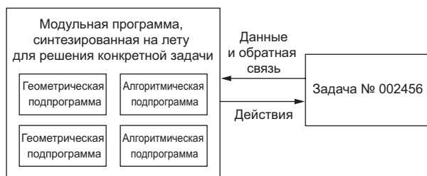
Рис. 9.5. Программа, сгенерированная одновременно на основе геометрических (распознавание шаблонов, предсказание) и алгоритмических (рассуждения, поиск, память) примитивов
