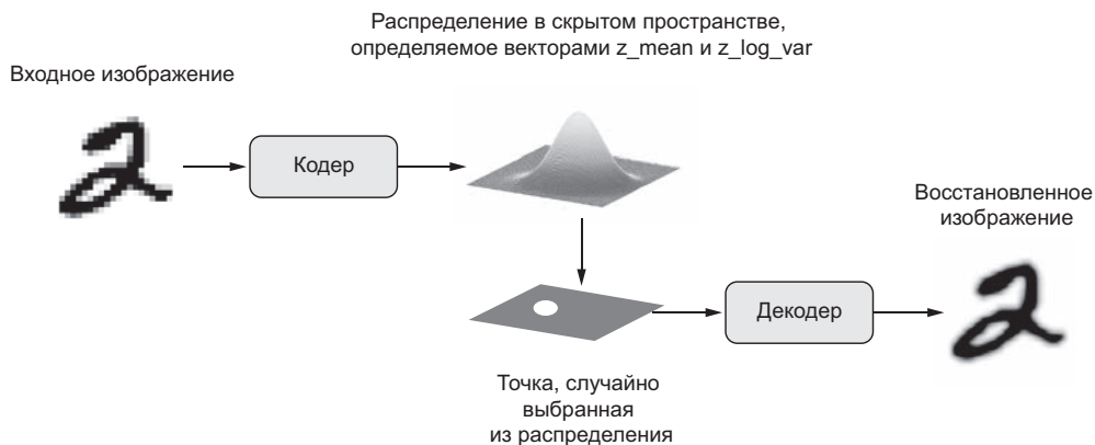
Рис. 8.13. Вариационный автокодировщик отображает изображение в два вектора, z\_mean и z\_log\_sigma , которые определяют распределение вероятности в скрытом пространстве, используемом для выбора точки для декодирования
